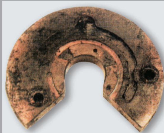
Cojinete de apoyo con el depósito de aceite carbonizado (alta temperatura o mala calidad del aceite).
