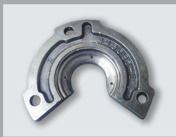
Desgaste de las rampas de lubricación debido a la fricción con el collar.
