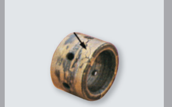
Cojinete radial con ralladura debido al sobrecalentamiento.
