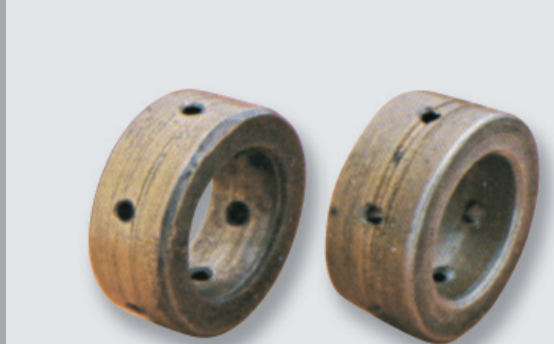
Cojinetes radiales dañados por causa de aceite contaminado.
