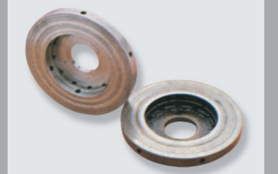
Collar dañado por trabajar con aceite contaminado.
