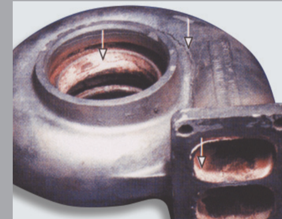
La alta temperatura raja la carcasa de turbina, cambia su color o provoca la rajadura del material en las superficies internas.
