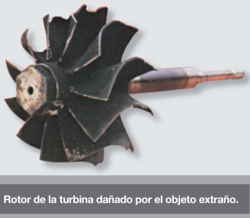
Rotor de la turbina dañado por el objeto extraño.
