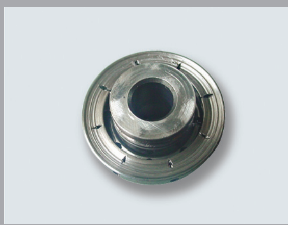
Desgaste por causa del rozamiento entre el collar y frente del plato.
