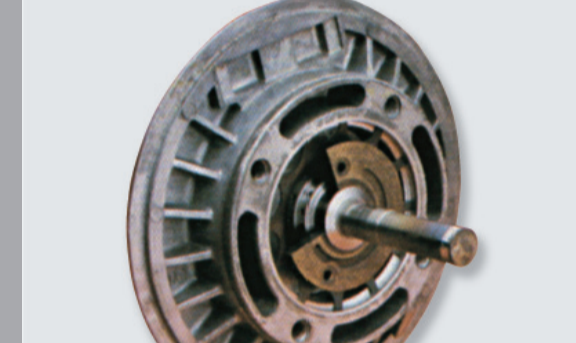
Rotura del eje debido a la falta de aceite.
