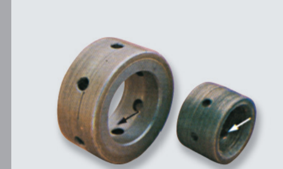
Aceite contaminado también puede dañar el diámetro interno de los cojinetes.
