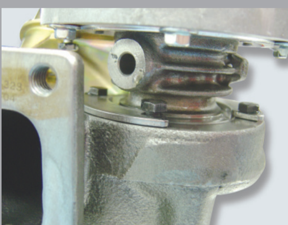
Alteración del tornillo de fijación de la Carcasa de la Turbina.
