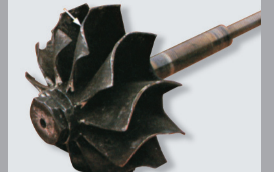
Roco del rotor de la turbina debido a la falta de aceite.
