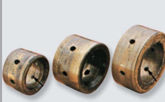
Cojinete radial con los agujeros de pasaje de aceite obstruido.
